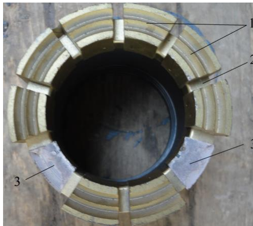
Рис.1- Макет коронки с эксцентриситетом торца матрицы (КИТ): 1 – алмазосодержащие сектора; 2 – малый промывочный паз; 3 – место удаленных алмазосодержащих секторов
