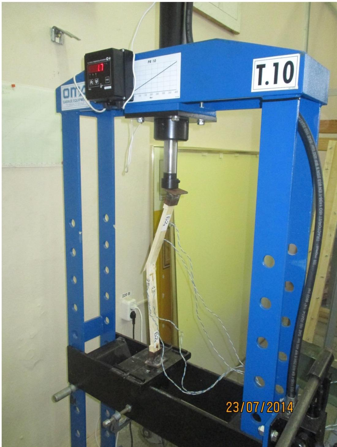
Рис. 13. Характер разрушения образцов при испытаниях на устойчивость.
