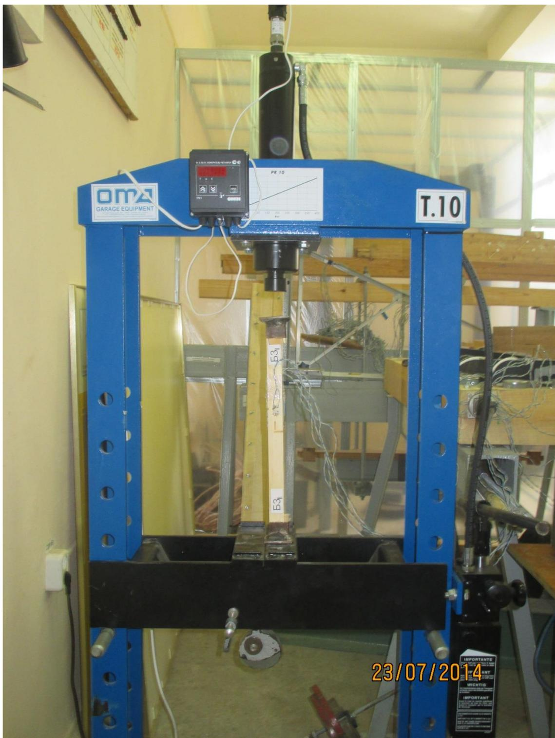
Рис. 12. Вид образца в установке для испытаний на сжатие.
