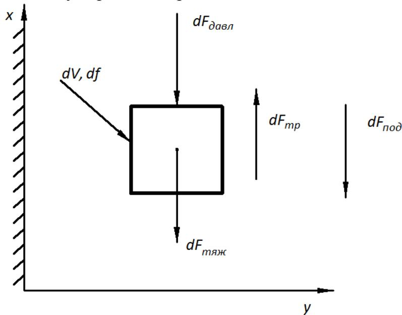
Рис. 2. Расчетная схема теплового потока
