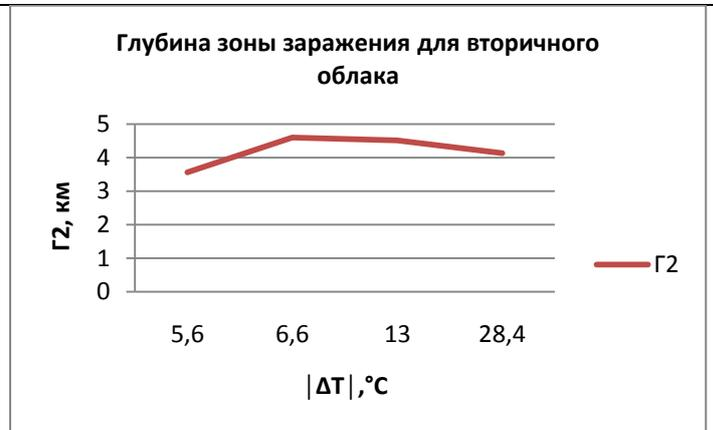
Рис.8.4 График зависимости  $\Gamma_2$  от температуры окружающей среды
