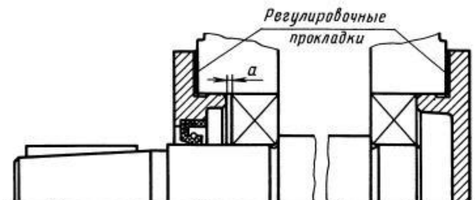
Рис. 11 Схема регулирования подшипников набором тонких металлических прокладок
