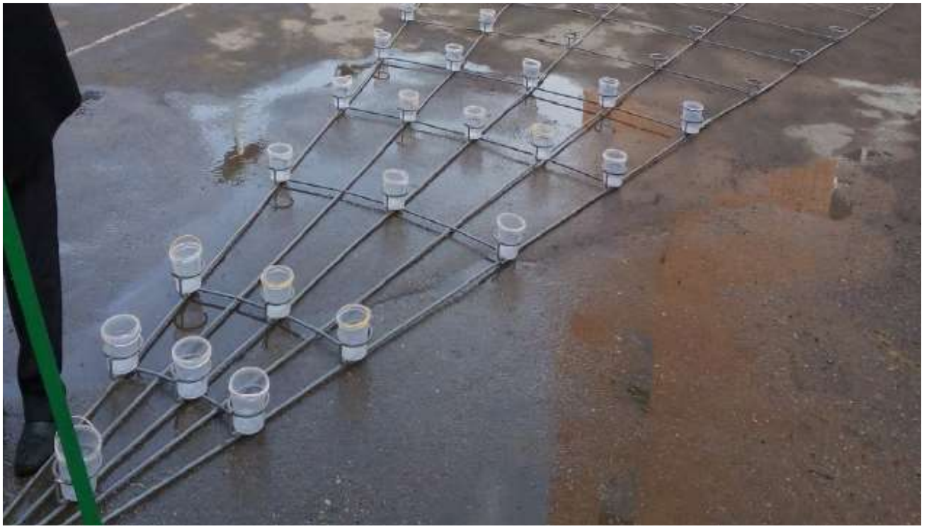
Рисунок. 3.5 – Расстановка дождемеров при лабораторных исследованиях
