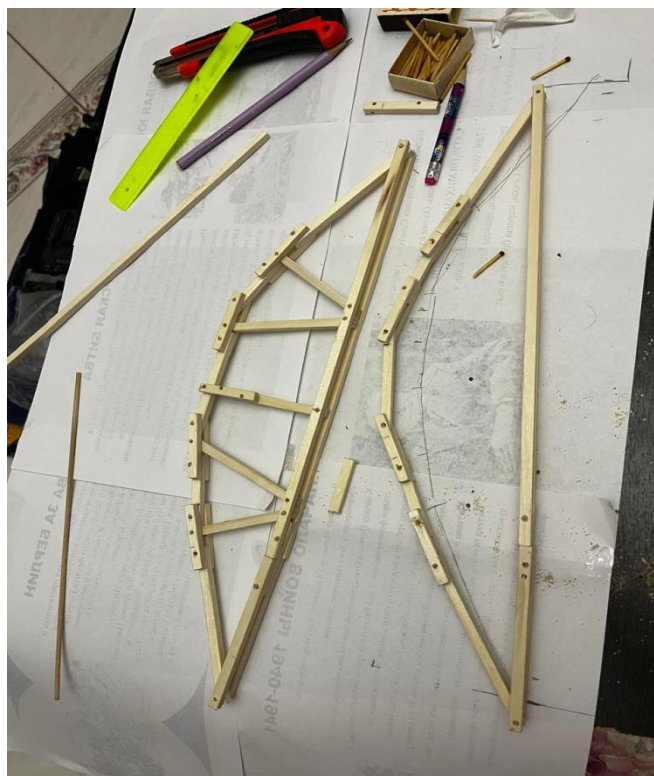
Рисунок 11 - Изготовление арок моста
